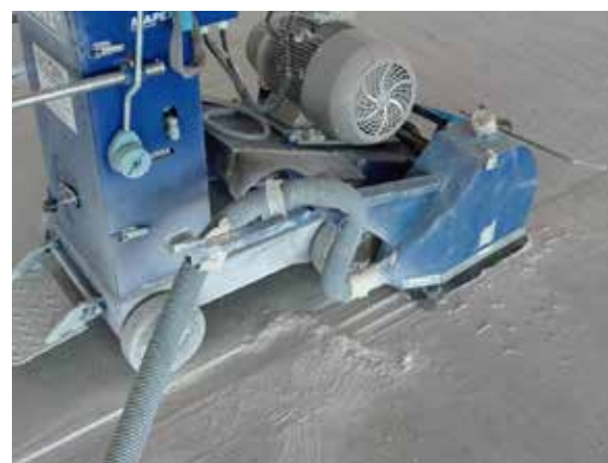
Multidisco per fresatura a secco con base planare a "U" e aspirazione polvere, di larghezza variabile da 5 a 100mm con profondità adeguata. Per interventi di ripristino e rinforzo, per giunti di costruzioni e dilatazione in pavimenti industriali.
