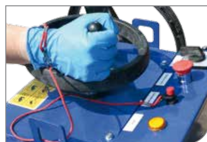
Cordino a strappo a norma di sicurezza di serie che spegne il motore in caso di emergenza (modelli GS)
