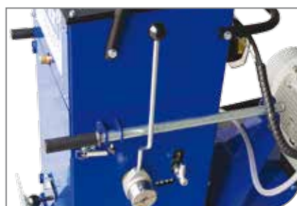
Comoda leva d'avanzamento avanti-indietro con azionamento lento progressivo (modelli GSA-GXL)
