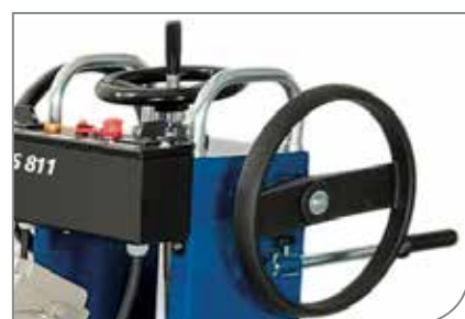
Due volanti Ø 370mm per l'avanzamento a catena ridotto di R.R. = 1:2 per GS811 e GS15
