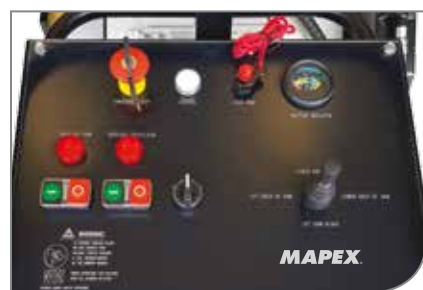
Consolle intuitive dei comandi per la gestione automatica di tutte le funzioni della macchina (modelli GXL)
