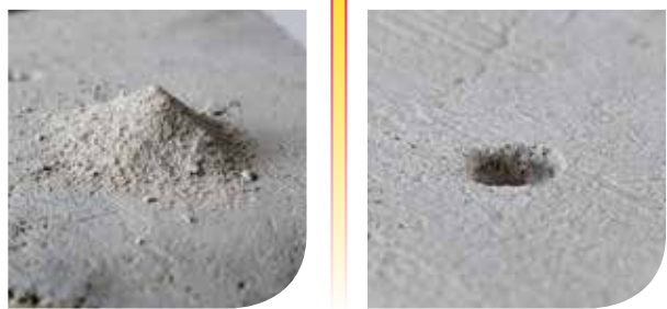
Esempio: una foratura tradizionale Ø 32 mm profonda 1 m produce circa 1 kg di polvere
